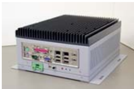
Lüfterloser Embedded-PC für den Einbau in Schaltschränke oder Point-of-Sale-Automaten
