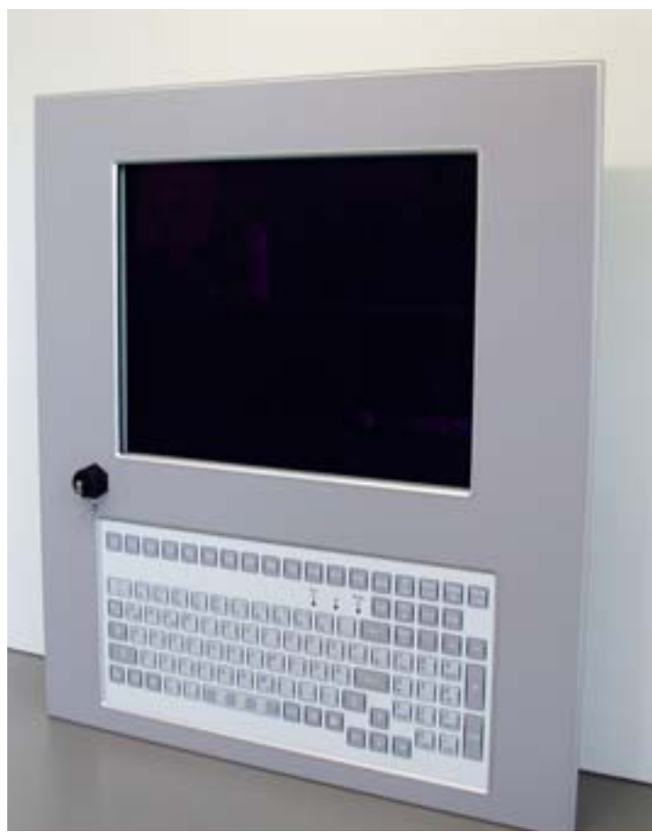
Panel-PC-Bediengerät in IP 65
